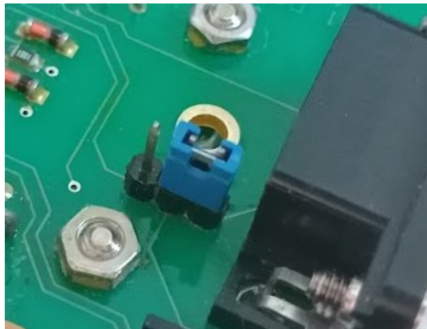
Poloha jumperu pro vnitřní konektor
