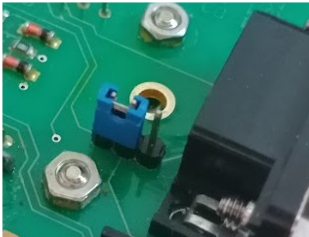
Poloha jumperu pro vnější konektor
